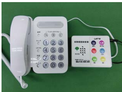
▲自動通話録音機（右）設置イメージ 電話回線と電話機の上に設置します
